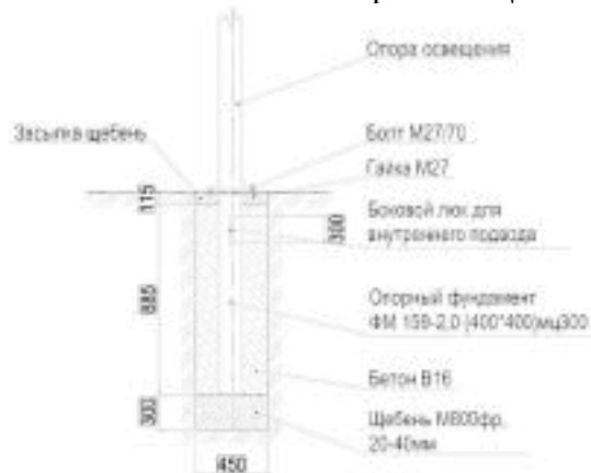
3.17 Схема установки светильника в газоне
